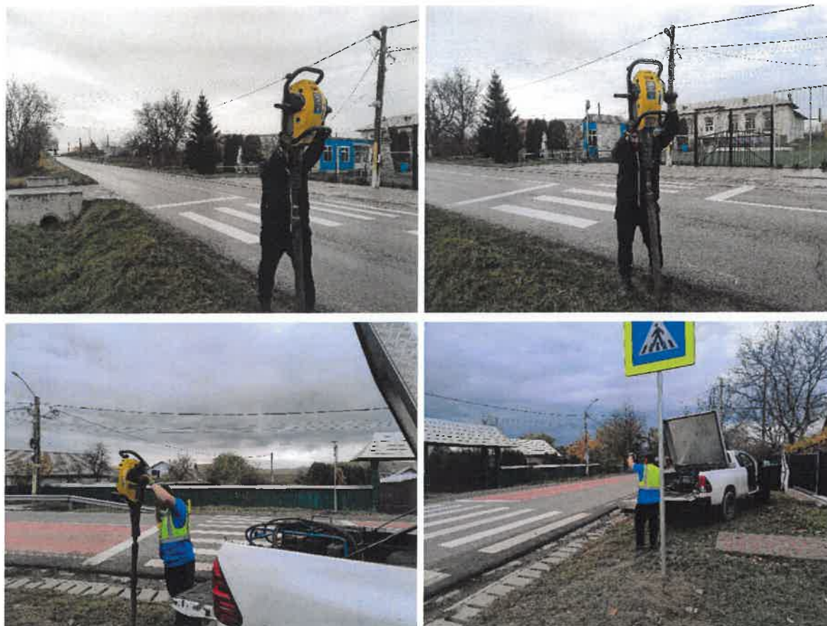
Figura 17. Realizare foraje geotehnice
